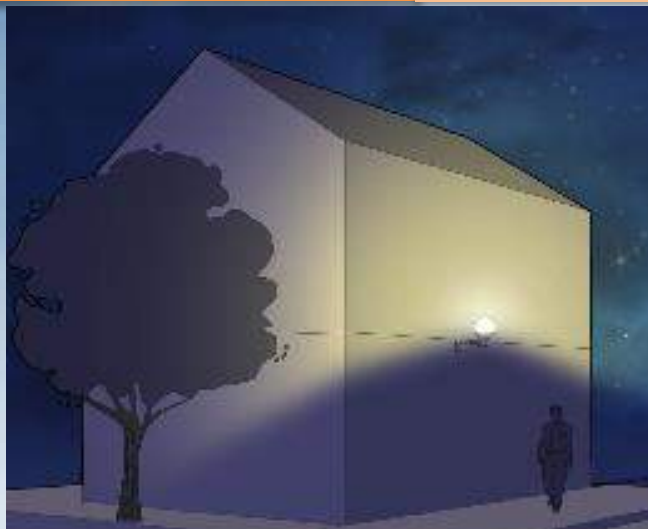
Éclairage très mauvais
